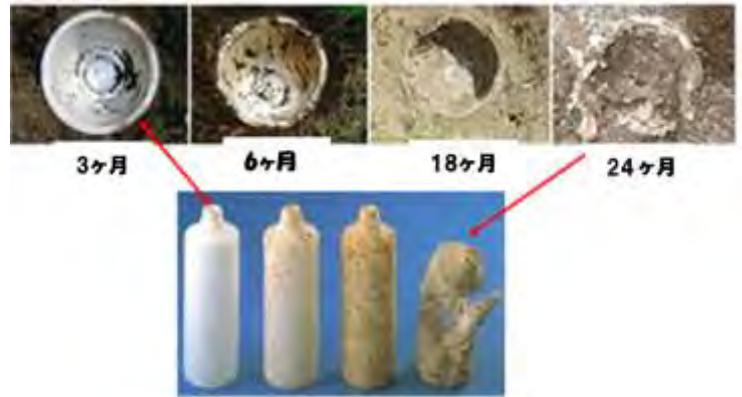
図1 バイオプラの自然分解プロセス
