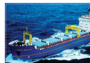
PNTL船 全長: 約100m 全幅: 約16m 総トン数: 約5,000t
