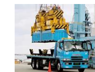
輸送トラック 車両重量: 約9.7t 最大積載量: 約15.2t
