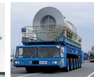
輸送車両 車両重量: 約33.7t 最大積載量: 約135t
