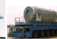
輸送車両 車両重量: 約33.7t 最大積載量: 約135t
