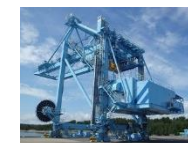
50t 橋形クレーン
