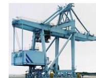
150t 橋形クレーン
