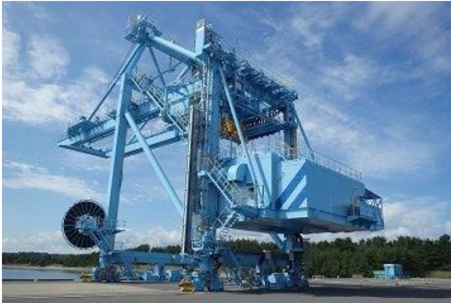
50トン橋形クレーン： 低レベル放射性廃棄物輸送容器 天然六ふっ化ウラン用輸送容器
